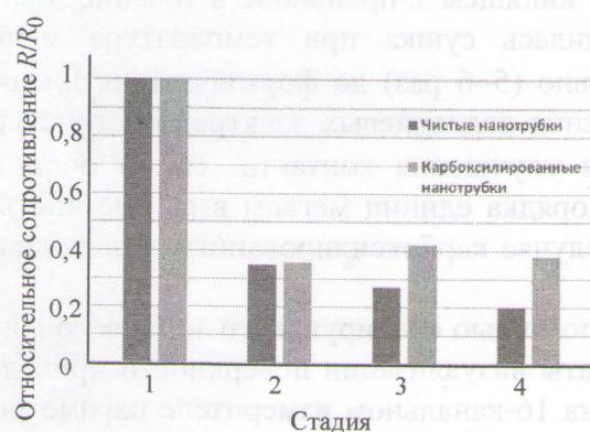
Рис.2. Изменение сопротивления сенсорных структур во время сборки: 1 – стадия нанесения ОСНТ и напыления контактов; 2 – стадия нанесения CDI-Tween; 3 – стадия нанесения аптамера; 4 – стадия обработки этаноламином
