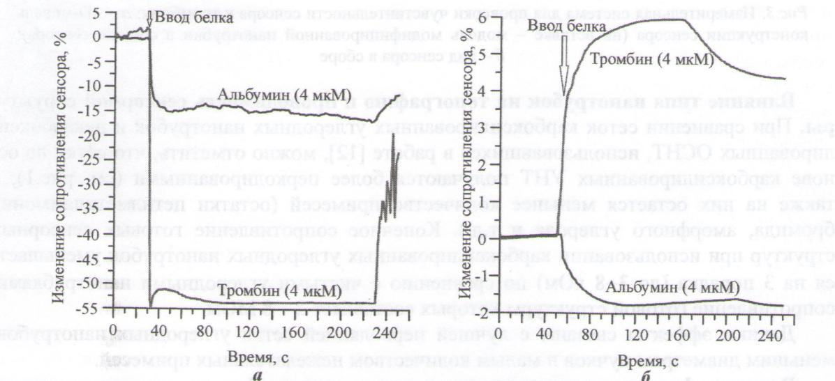
Рис.4. Отклик биосенсоров на основе чистых (а) и карбоксилированных (б) углеродных нанотрубок на экспонирование тромбином и альбумином
